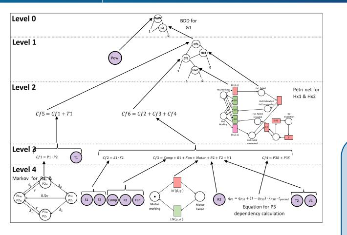
Cf1 = P1.P2 Cf2 = S1.S2 Cf3 = Comp + R1 + Fan + Motor + R2 + T2 + V1 Cf4 = P3S + P3R Cf5 = Cf1 + T1Cf6 = Cf2 + Cf3 + Cf4
